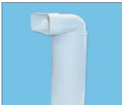
Umlenkstück mit Rohr zum Umlenken der Abluft um 90° mit gleichzeitigem Übergang von rund auf eckig mit Muffe. Rohr ggf. bauseits ablängen!
