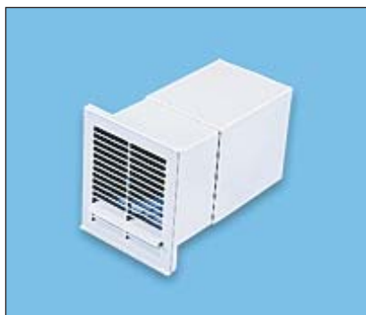
Teleskop-Ab- und Zuluft-Mauerkasten mit innenliegender Rückstauklappe, für max. 600 m 3 , mit Tropfnase, Stufenstutzen Ø100/125 mm, max. ausziehbar bis 440 mm Anschlussstutzen rund
