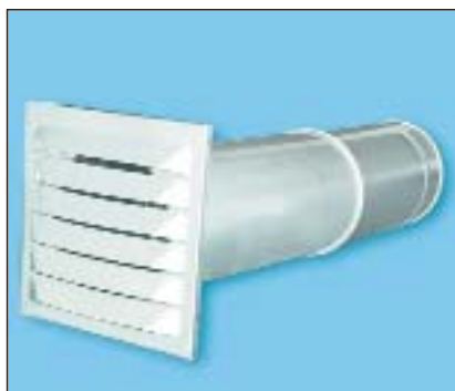
Teleskop-Mauerkasten komplett aus Edelstahl Ausziehbar bis max. 480 mm Rückstauklappe mit Rückholfeder Ohne Muffe
