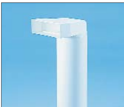
MAXI KANAL-Umlenkstück mit Rohr zum Umlenken der Abluft um 90° und gleichzeitig von rund auf eckig, geeignet für Oberschränke (Engstellen) Farbe: weiß
