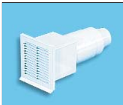
Teleskop-Mauerkasten mit innenliegender Rückstauklappe, Anschlussstutzen Ø 100/105/120/150 mm Mauerdurchbruch: 175 x 175 mm Teleskopisch ausziehbar bis 480 mm Gittermaß: 220 x 230mm (inkl. Tropfnase) Gehäusefarbe: grau Außengitter: siehe Ausführung
