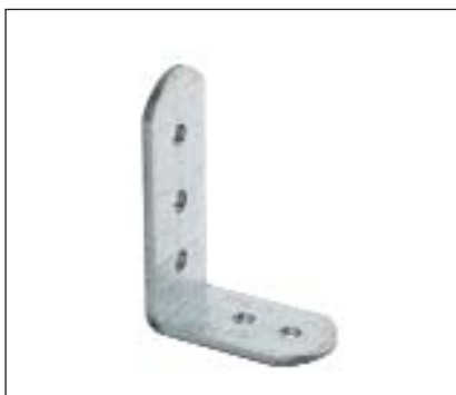
Blattwinkel Materialstärke 2 mm, Senk-Schraublöcher Ø 4 mm, Schenkelmaß 48 x 31 mm, Breite 19 mm
