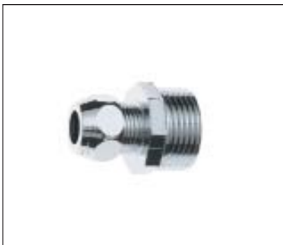
Spezialanschluss „Schlauch an Kupferrohr“ besonders bei Untertischanschlüssen etc., Quetschverschraubung 3/8" x 10 mm, mit Reduziernippel 3/8" x 3/4"
