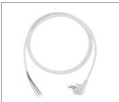
Netzschur (mit angespitztem SCHUKO-Winkel- stecker) Zum Anschluss ortsveränderli- cher Stromverbraucher, bei mittlerer mechanischer Beanspruchung, für Haus- und Küchengeräte auch in feuchten Räumen DIN 49441 (VDE-PR) Farbe: weiß
