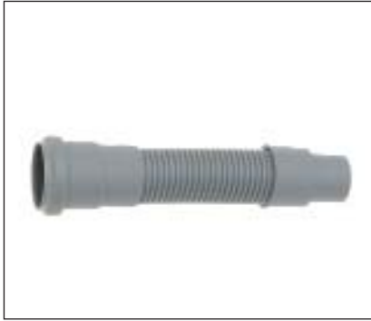
HT-Rohr, flexibel einerseits mit HT-Muffe 50 mm, andererseits mit gerader Muffe 40/50 mm
