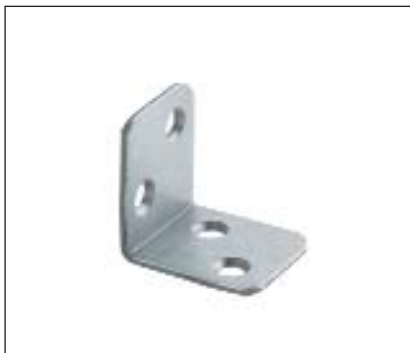
Winkel Materialstärke 2 mm, Senk-Schraublöcher Ø 4 mm, Schenkelmaß 30 x 30 mm, Breite 25 mm
