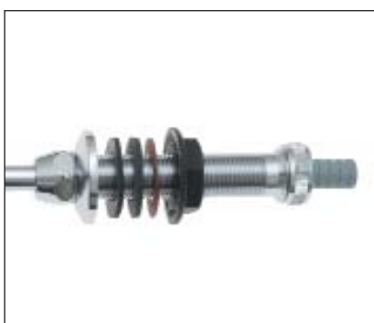
Spüldurchführung, komplett für den problemlosen Anschluss einer Spül- oder Waschmaschine an der Zapf- stelle (Schwenkbatterie oder Auslauf- hahn). Ein eleganter und sauberer Anschluss ohne Beschädigung der Wand oder Fliesen Inkl. Schlauchverschraubung, Kupferrohr 12 x 500, 3/4" Überwurfmutter mit Dichtring, Verstellbereich 70 mm
