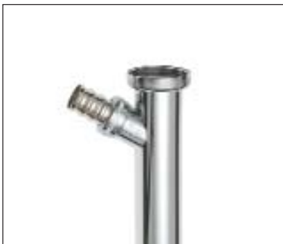
Verstellrohr Länge 200 mm, für Röhren- und Flaschen-Geruchverschlüsse, mit Schlauchverschraubung 3/4" für den Anschluss der Ablaufschläuche von Waschmaschinen, Messing verchromt
