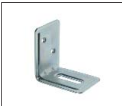
Winkel Materialstärke 3 mm, 3 x Schraubloch Ø 4,5 mm, 1 x Langloch Ø 6 mm, 27 mm, Schenkelmaß 52 x 52 mm, Breite 40 mm
