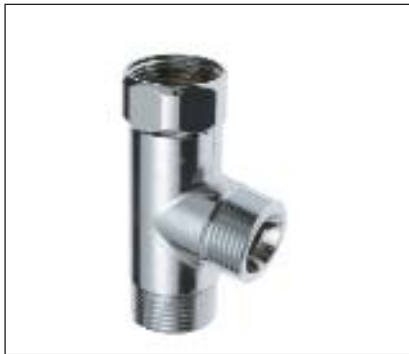
Verteilerstück 1/2" verchromt, für gleichzeitigen Daueranschluss von Wasch- und Geschirrspülmaschine, mit Flügelmutter, 3/4" Innengewinde, 2 x 3/4" Außengewinde, für 1/2" Schlauchverschraubung
